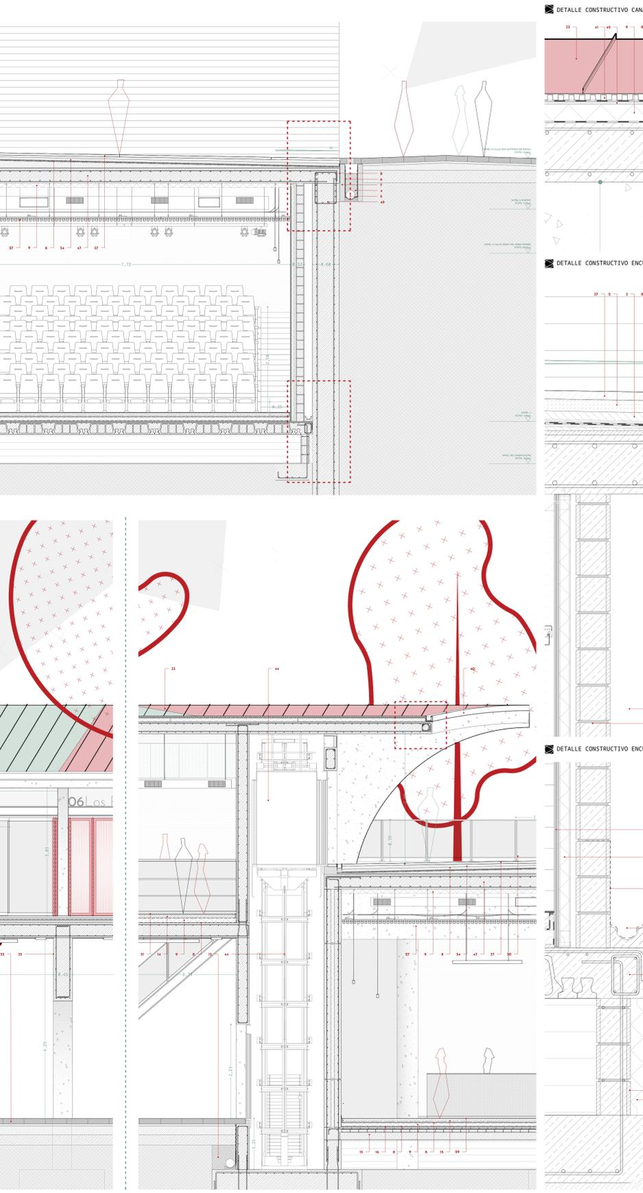
DETALLE CONSTRUCTIVO CANALÓN CUBIERTA CURVA 1:8
