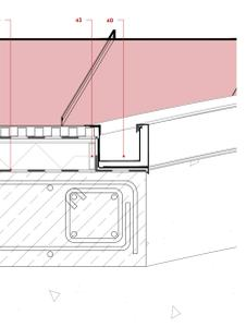
DETALLE CONSTRUCTIVO ENCUENTRO DE LOSA CON MURO PANTALLA 1:10
